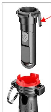
Nel caso in cui risulta difficoltoso l'inserimento dell'alimentatore per la ricarica USB, è possibile estrarre la torcia dal corpo del Multitac. Per estrarre la torcia fare pressione sulla lamella indicata al punto (B) della figura e contemporaneamente estrarre il supporto nero in figura (C) che contiene la torcia.
